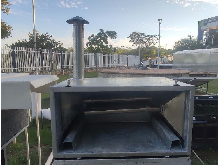
Figura 7 Vista interior del módulo de Biomasa
